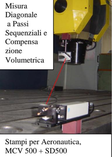
Misura Diagonale a Passi Sequenziali e Compensazione Volumetrica
