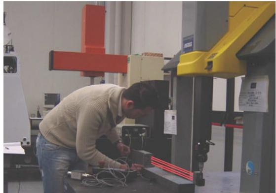
Contemporaneamente: Posizionamento, Angolo di beccheggio e Rettilineità su Macchina di Misura CMM con MCV2002
