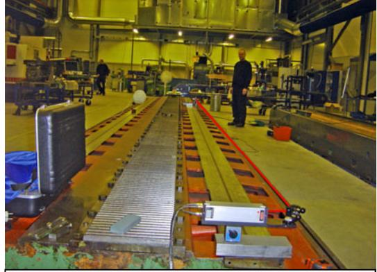
Retrofitting: Raschiatura di una Guida Misura di Rettilineità con MCV3500
