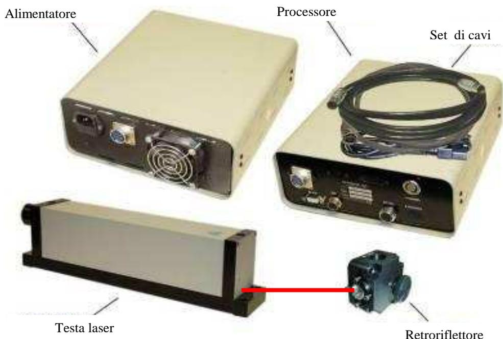
Il sistema laser , LDS1000 HS, è formato da una testa laser e da un retroriflettore, un processore di segnali, un alimentatore ed un set di cavi come illustrato qui sopra
